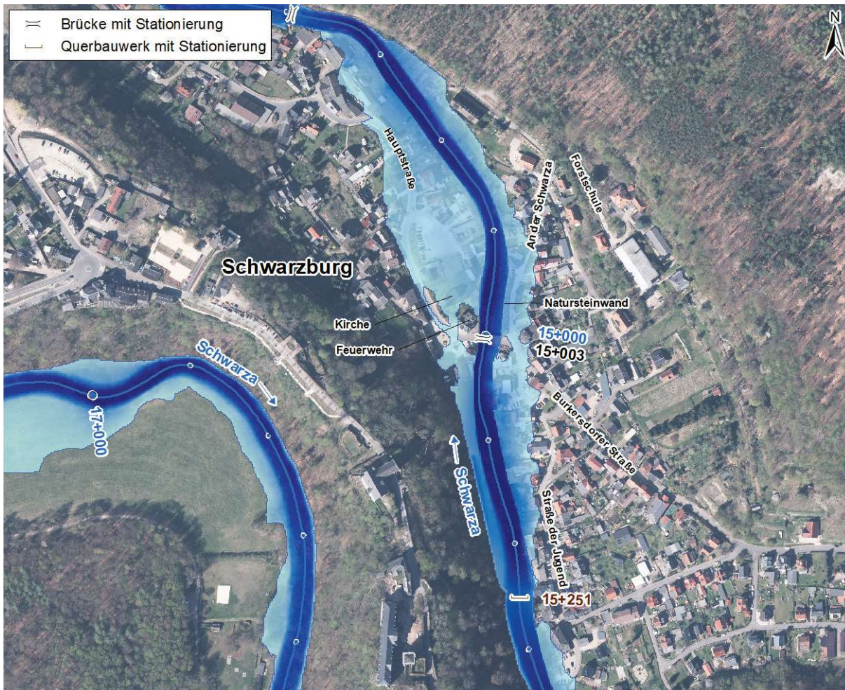
Abbildung 11.19: Schwarzburg, Istzustand - Überflutungen bei HQ 100 , M 1:5.000
